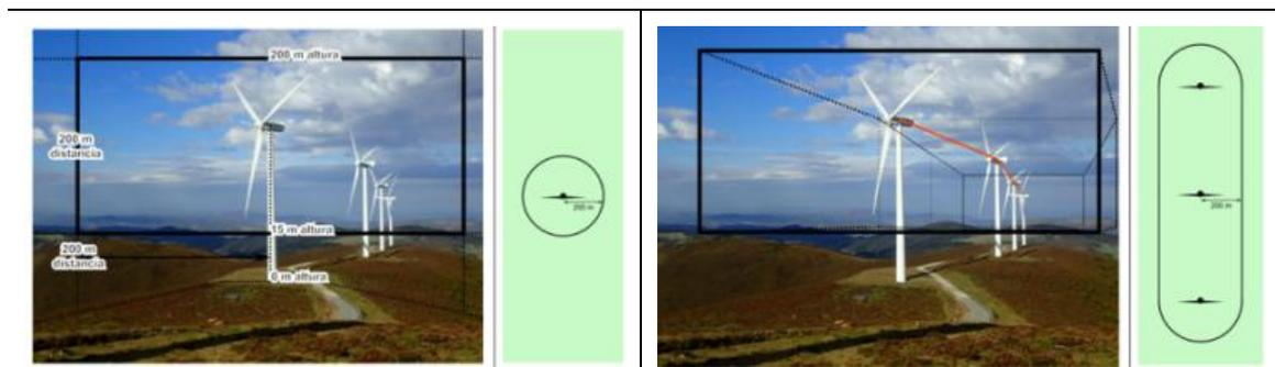
*Figura 2.1. Zona de riesgo para un aerogenerador*
