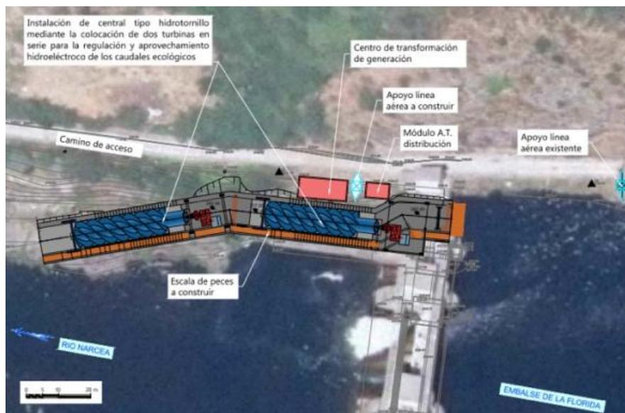
*Figura 1. Esquema general del proyecto “Aprovechamiento Hidroeléctrico del Caudal Ecológico en el Río Narcea en la Presa de la Florida”*
