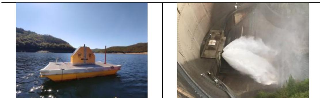
*Figura 6-7. Sistema de monitoreo con una sonda modelo YSI 6600 V2 y detalle de la suelta del caudal ecológico a través de la válvula de chorro hueco.*
