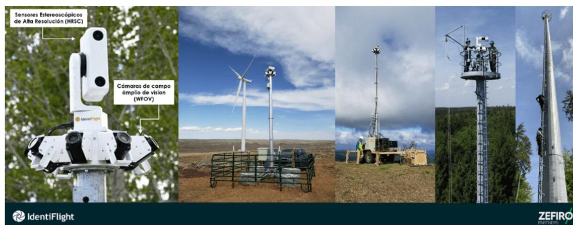
Figura 1. De izquierda a derecha. Detalle de las subunidades ópticas de IdentiFlight v5. Unidad sobre torre telescópica con base portable arriostrada. Unidad sobre torre telescópica en base móvil de grupo electrógeno autónomo. Unidad sobre torres atornilladas de acero galvanizado.
