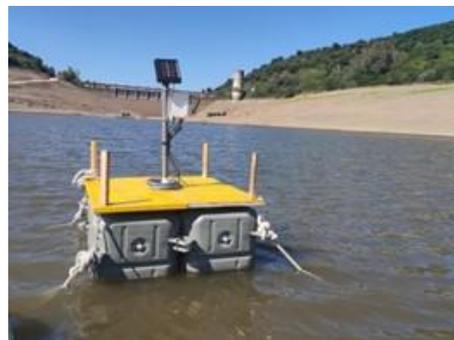
*Figura 14-15. Sistema de monitoreo con una sonda modelo RX3004 Data Logger de HOBO*
