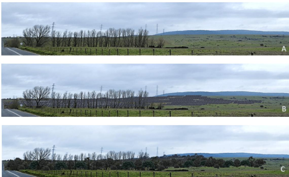
*Figura 8. Comparativa gráfica de la zona de implantación de una planta solar fotovoltaica en tres escenarios: A: escenario original, B: implementación del proyecto y C: incorporación de pantalla vegetal como medida de mitigación visual*
