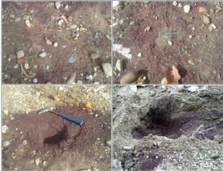
Figura 2. Fotografías del aspecto superficial de los residuos en las zonas ajardinadas del barrio de La Almozara (nótese el color granate habitual y las coloraciones verdosas que se producen por precipitación superficial de óxidos y carbonatos de cobre).
