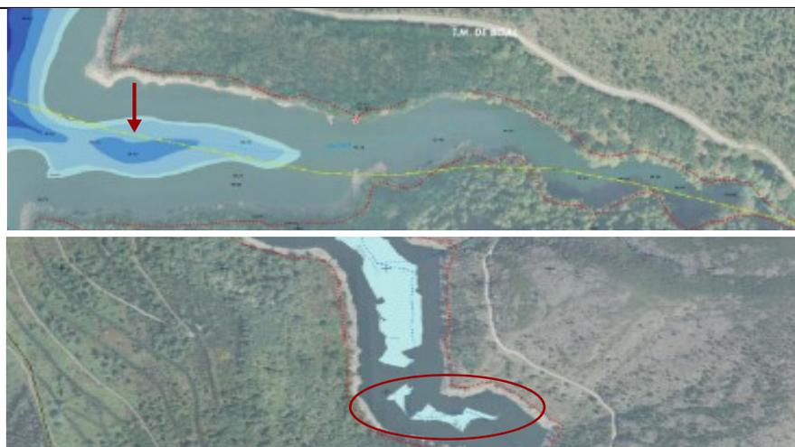
Figura 9. Identificación de las zonas susceptibles de generar pozas aisladas en el embalse de Grandas de Salime tras el estudio batimétrico.
