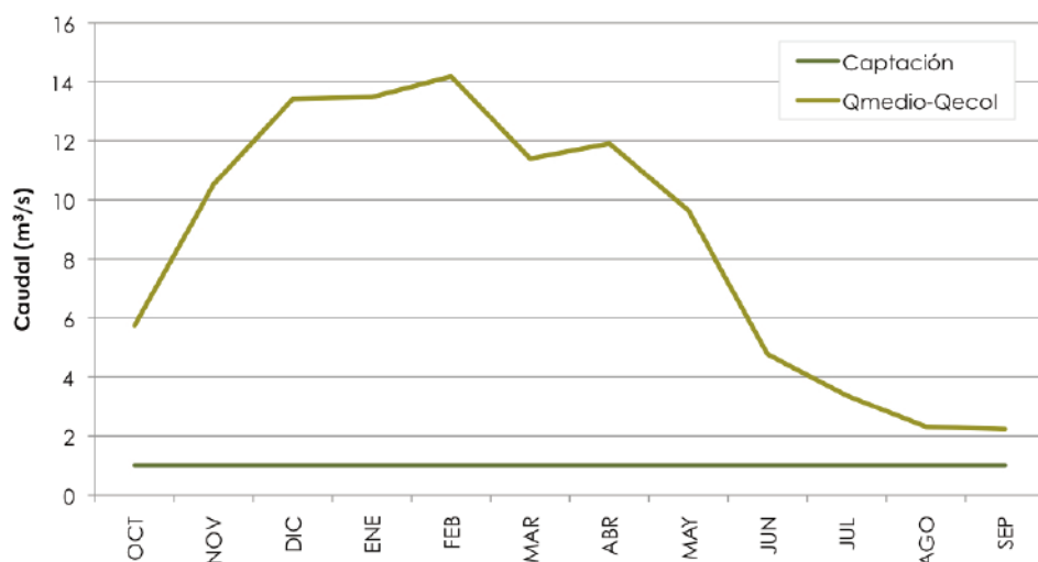
Figura 7. Caudales medios mensuales (descontando el caudal ecológico establecido por CHC) de la Estación de Aforo de Trevías (1970-2010), frente a la captación estimada para el proyecto. Fuente: Confederación Hidrográfica del Cantábrico Occidental (CHC).
