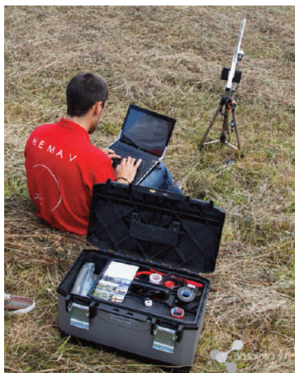
Figura 4. Sistema de guiado del dron desde tierra.
