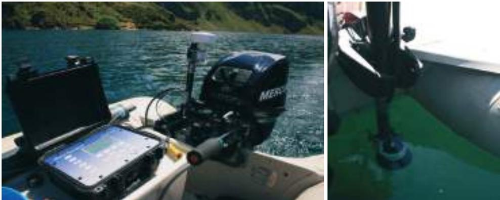
**Figura 1.** Ecosonda MIDAS SURVEYOR y GPS asociado (imagen izquierda). Transductor sumergido (imagen derecha).
