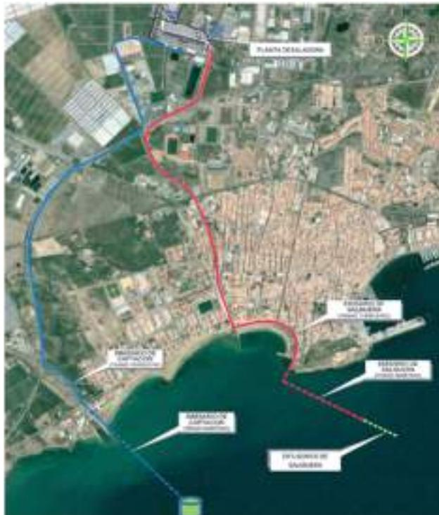
**Figura 1.** Esquema de componentes de una IDAM ( Desaladora de Águilas, Murcia).
