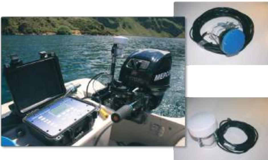
Figura 1. Sonda batimétrica utilizada durante los trabajos de campo.
