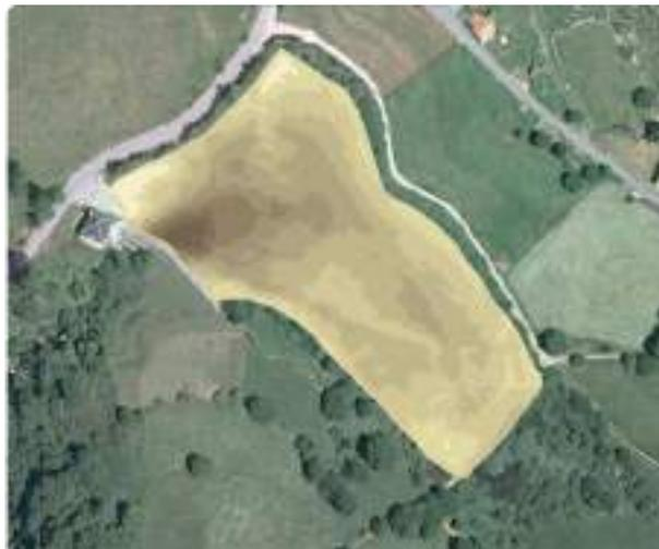
**Figura 6.** Modelo de sedimentación tridimensional. Zonas más oscuras indican mayor sedimentación.
