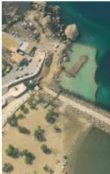
**Figura 3.** Pantalla conteniendo la turbidez generada en la remoción de tierras (Desaladora de Águilas, Murcia).
