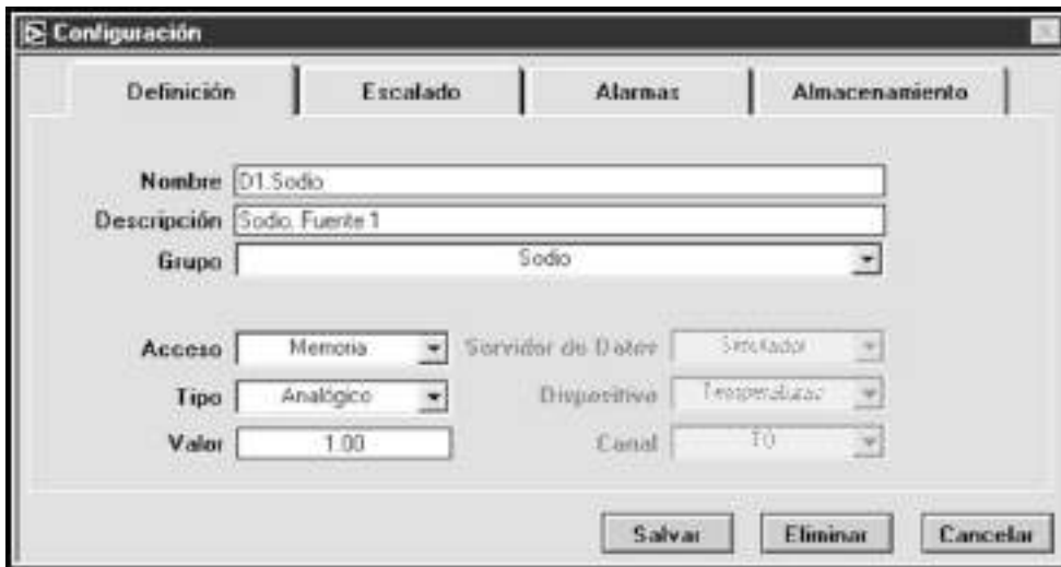
Figura 3. Pantalla de configuración. Esta pantalla permite configurar cada una de las señales (entradas y salidas) del sistema de control, sus escalas, alarmas y modo de almacenamiento
