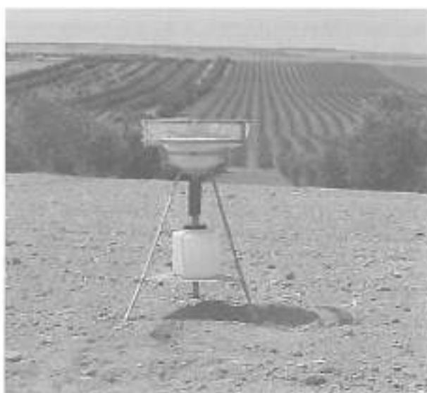
*Detalle de uno de los colectores de partículas sedimentables utilizados en el muestreo realizado en Villasequilla de Yepes.*
